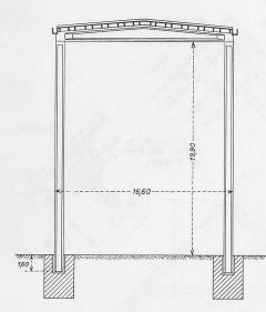
Bild 3 (links). Ofenhallen-Querschnitt, Binderabstand 12 m, Fundamentblöcke mit Aussparungen zum Einstecken der Stützen, 1:400
