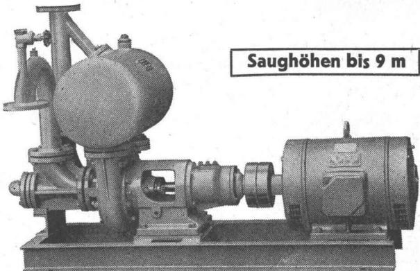
Leistungen 1—500 l/s. Kein Bodenventil. Keine Klappe im Saugstutzen. Keine Hilfs-Vakuumpumpe. Jederzeitiges automatisches Ansaugen auch nach Lufteintritt im Saugrohr. Keine reibenden, sich abnutzenden Dichtungsflächen; daher **störungsfrei** auch bei **Schlamm-, Sand- und Kiesförderung**.
