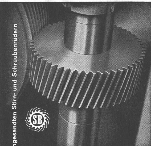
Zähneschleifen an eingesandten Stirn- und Schraubenrädern
