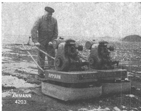
Zwei Bodenverdichter Nr. 5 gekuppelt
