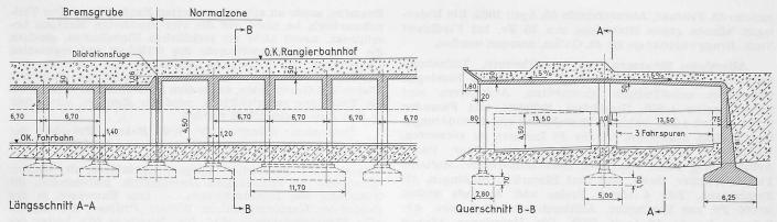
Bild 2. Autobahn-Galerie Schweizerhalle, Schnitte 1:500. Man beachte die aussergewöhnlichen Abmessungen der Eisenbetonkonstruktion
