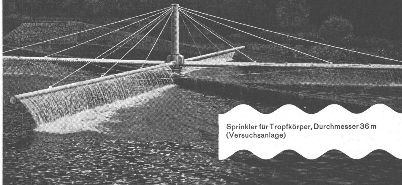
Sprinkler für Tropfkörper, Durchmesser 36 m
