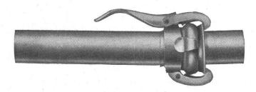
aus Bandstahl, überlappt, geschweisst, absolut dicht, stark abwinkelbar, feuerverzinkt. Durchmesser: 50, 62, 70, 89, 108, 133 und 159 mm
