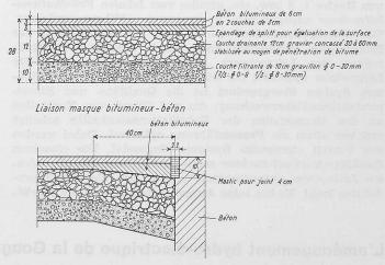
Fig. 21. Détails 1:20 du masque du bassin de Motec
