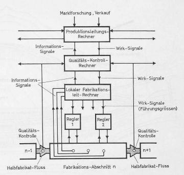
Bild 10. Prinzipielles Blockschema eines automatischen Fabrikationsbetriebes
