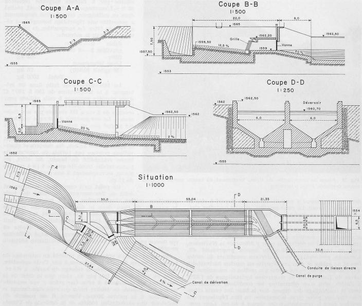
Fig. 24. Prise d'eau sur la Navisence à Motec
