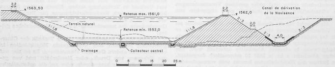
Fig. 20. Bassin de Motec, coupe en travers 1:800
