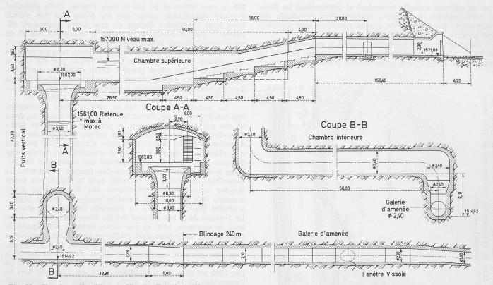
Fig. 28. Chambre d'équilibre de Vissoie. Echelle 1:400
