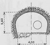
Fig. 16. Conduite forcée Barneusa-Motec, profil en long 1:6000, coupes 1:300
