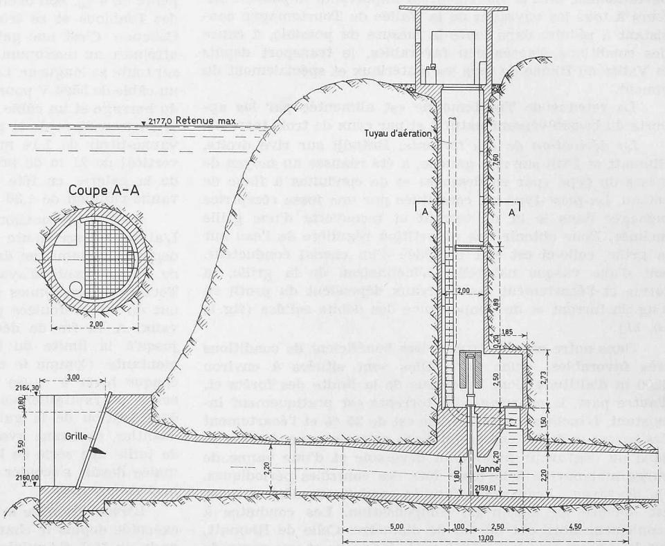
Fig. 13. Prise d'eau dans le bassin de la Tourtemagne et puits de la vanne. Echelle 1:250 (Coupe 1:125)
