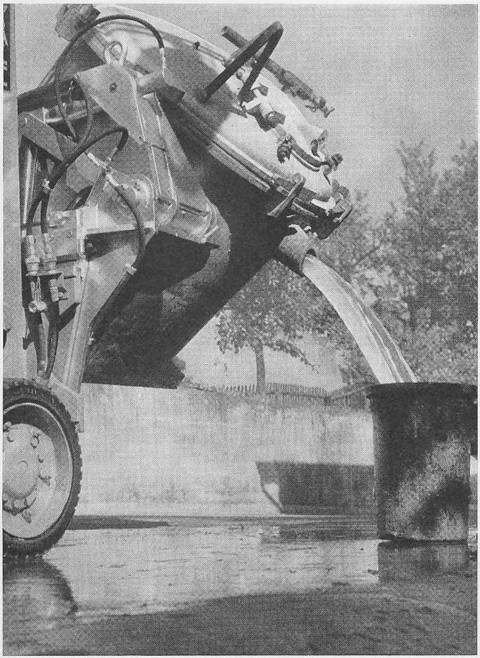
und links eingebaut ist. Auf diese Platte baute man eine schwenkbare Haltevorrichtung für die Aufnahme des Schmelzriegels. Die ganze Haltevorrichtung ist in einem Dehzapfen gelagert. Die Kippvorrichtung beruht auf einem System von zwei automatisch nacheinander betätigten Zylindern, wobei der untere einfacher, der obere doppelt wirkt. Da der Kippwinkel  $100^\circ$  beträgt, kann das Fließgut vollständig auslaufen.
