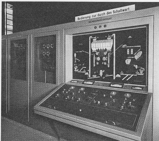
Bild 22. Steuerpult mit Leuchtschaltbild für die Sandaufbereitungsanlage in der Stahlgießerei
