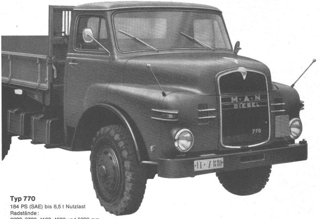
184 PS (SAE) bis 8,5 t Nutzlast Radstände: 3200, 3700, 4100, 4600 und 5200 mm Dreiseitenkipper mit oder ohne Allradantrieb, Frontlenker, Sattelzugwagen und Chassis für
