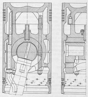
Bild 1. Kolben eines MaK-Zweitakt-Dieselmotors
