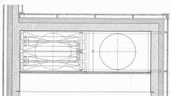
Bild 2. Der Luftkühler im Schnellgefriertunnel, Masstab 1:50. Man beachte die allseitige Ummantelung der Nachbarräume mit einer Verschalung aus Tannenholz
