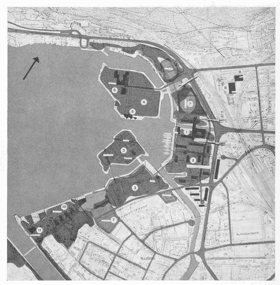
Der Damm zwischen dem Hafen und der Badebucht hat eine Behinderung des Schiffs- und speziell des Badebetriebes zur Folge. Die an die Sportplätze anschliessenden Wasserflächen beeinträchtigen teilweise deren Benützung. Der Versuch, die stark zerrissene Uferlinie durch Baumpflanzungen zusammenzufassen, ist nicht gelungen. Die Lage des Hotels als Hochbau ist städtebaulich wohl verständlich; hingegen ist die Wirtschaftlichkeit an dieser Stelle fraglich.
