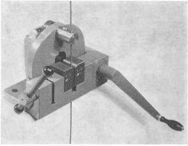
Bild 20. Apparat für Hin- und Herbiegeversuche Typ BT 8 zur Prüfung von hochwertigen Stahldrähten  $\emptyset$  4 bis 8 mm
