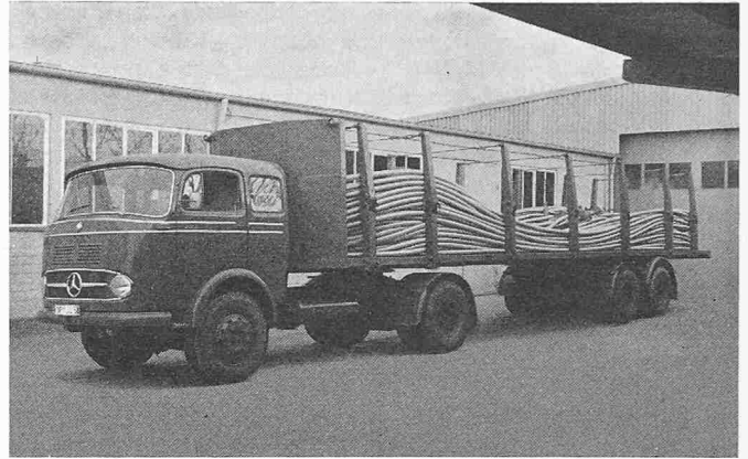
Bild 18. Mit ovalen Ringen beladener Tieflade-Transporter in Deutschland (Photo Suspa GmbH, Augsburg u. Langenfeld)
