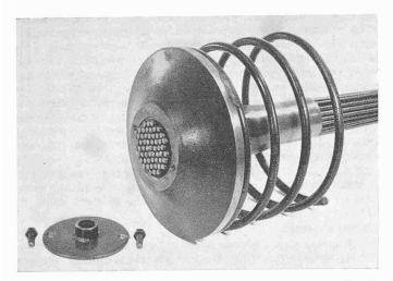
Bild 10. Fester BBRV-Kabelanker Typ E 220 (55 Drähte Ø 7 mm), bestehend aus Ankerplatte und Grundkörper (dieser in Platte eingeschraubt). — Links unten: Halteplatte für Drahtköpfchen samt Befestigungsschrauben
