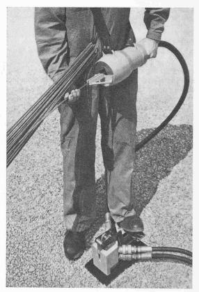
Bild 8. Hydraulisches Stauchwerkzeug mit Fusspedal-Bedienung, kleinerer Typ für Draht ∅ bis 7 mm
