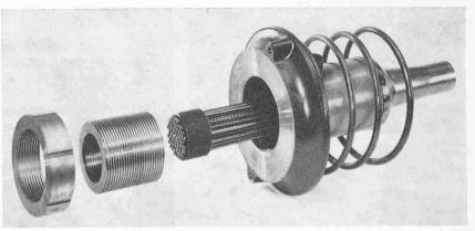
Bild 11. Grundkörper mit erweiterter Randzone Bild 12. BBRV-Kabelanker Typ C 220 (55 Drähte Ø 7 mm), bestehend aus Ankerplatte mit Uebergangsrohr und Spirale, Grundkörper, Zughülse und Ankermutter
