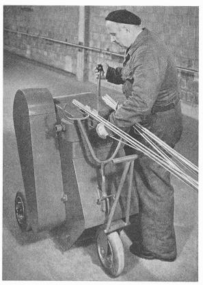
Bild 7. Aufstauchen der Drähte mit Drahtstauchmaschine Vogt (mechanisches Gerät für Drähte bis 8 mm Ø)
