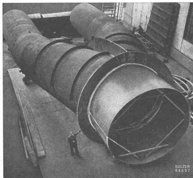
Wir befassen uns mit der Herstellung und Montage vollständiger Druckleitungsanlagen:
