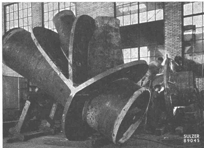
Wir befassen uns mit der Herstellung und Montage vollständiger Druckleitungsanlagen:
