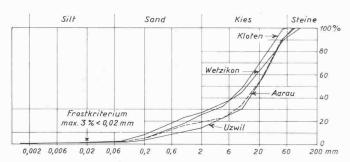
Bild 1. Summationskurven der Kornverteilung von Fundationsmaterial für Kunsteisbahnen
