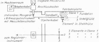
Bild 2b. Verlegungsschema der Temperaturmesseinrichtungen
