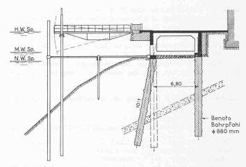
Bild 3. Wiederherstellung des eingestürzten Quais von Brissago, Schnitt 1:400
