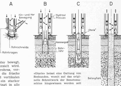
Bild 2. Bauvorgang beim Benoto-Verfahren
