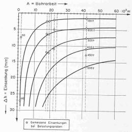
Bild 7. Diagramm der Bohrarbeit in Funktion der Pfahleinsenkung
