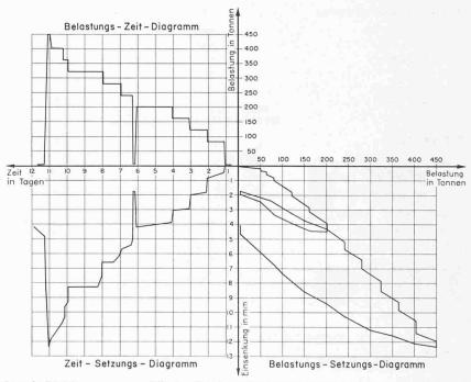
Bild 4. Belastungsprobe bis 450 t auf der Baustelle «Palme» in Zürich
