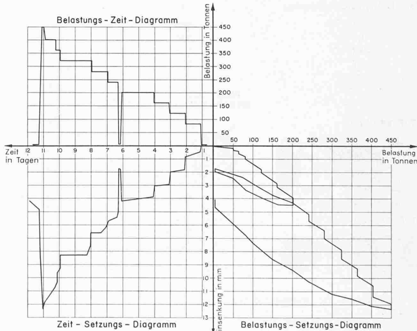
Bild 5. Zeit-Last-Setzungs-Diagramme des Versuchs Bild 4
