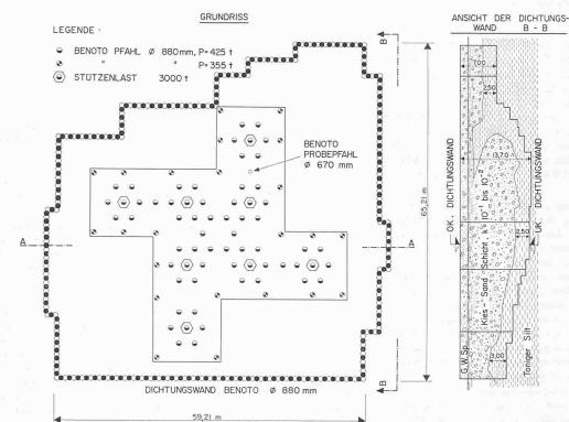
Bild 10. Dichtungswand und Pfahlgründung der Baustelle «Palme» in Zürich, Plan 1:800
