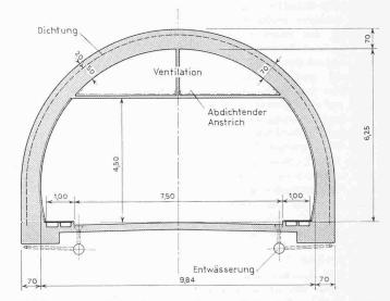
Unterirdische Längsverbindung Mittlere Brücke — Wettsteinbrücke, Normalprofil 1:150
