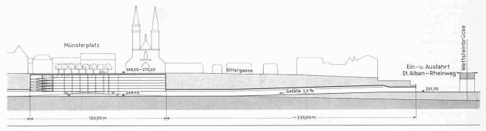
Bild 2b. Fortsetzung von Bild 2a: Durchführung der Längsverbindung unter der Parkgarage Münsterplatz
