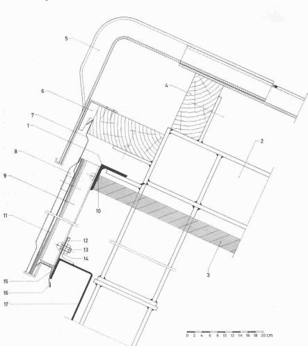
Bild 14. Details des Oberlichtanschlusses, Masstab 1:7
