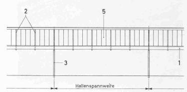
Bild 2. Uebersicht der patentierten Shedkonstruktion, Masstab 1:300. 1 Rinnenträger, 2 Shedquerträger, 3 Hauptstütze, 4 Pfetten, 5 Fenster, 6 Dachfläche
