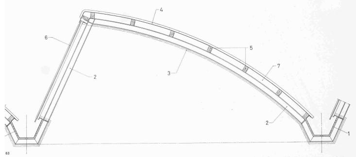
Bild 11. Shedquerschnitt 1:50 mit unten aufgehängter Isolierdecke. 1 Rinnenträger, 2 Shedquerträger, 3 Aufgehängte Isolierdecke, 4 Welleternit, 5 Holz- oder Stahlpfette, 6 Kittlose Verglasung, 7 Dachhohl raum
