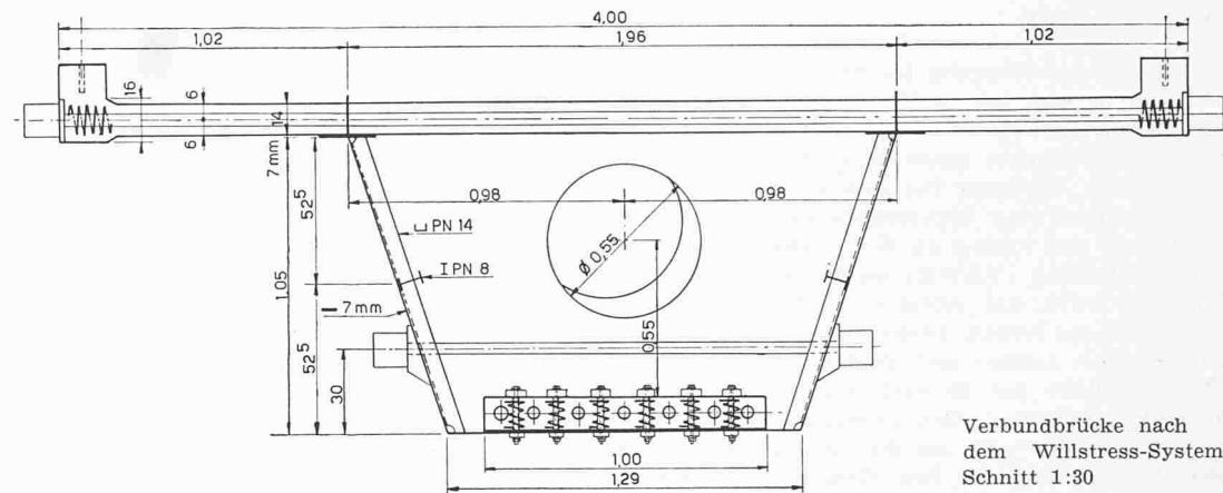
Verbundbrücke nach dem Willstress-System, Schnitt 1:30
