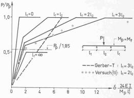
Bild 22. Last-Durchbiegungskurven für Dreifeldträger unter Einzellast
