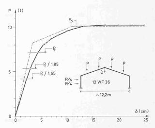
Bild 17. Last-Durchbiegungskurve eines Versuches an einem Hallenrahmen
