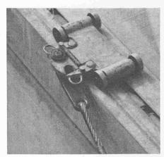
Bild 3. Mitnehmerschenkel mit Befestigungsvorrichtung für das Seil
