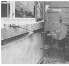
Bild 2. Mitnehmer an der Rampenkante mit Zugseil
