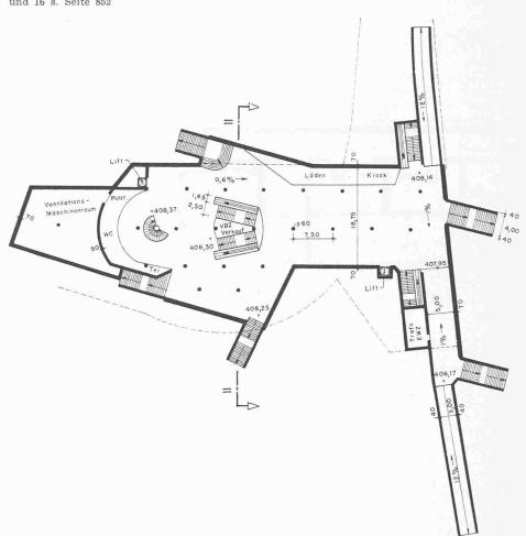
Bild 12. Fussgängerhalle der Station Sihlporte, Grundriss 1:800. Schnitt 11 siehe Seite 853
