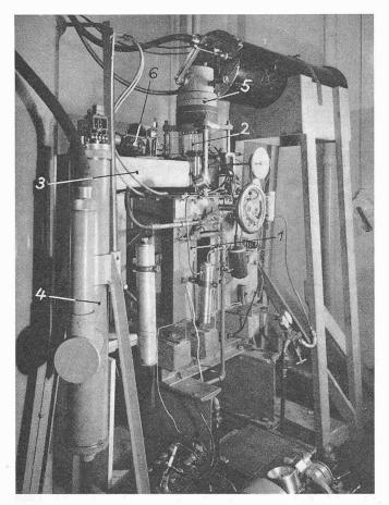
Bild 4. Ansicht des Abschussmodells. 1 Abschuss-Einrichtung, 2 Plexiglaszylinder, 3 Spülluft-Behälter, 4 Funken-Erzeugungsvorrichtung, 5 Funken-Strecke, 6 Stereoskop-Trommelkamera
