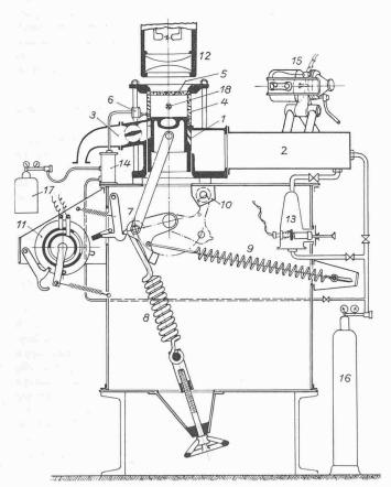
Bild 3. Abschussmodell zur Untersuchung der Spülströmung in Zweitakt-Zylindern
