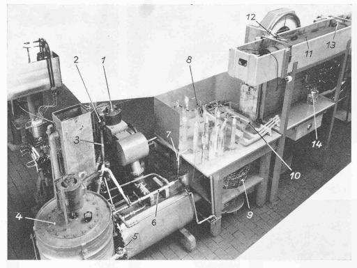
Am Motor hat diese Spülanordnung nicht jene guten Werte ergeben, wie diejenige des ersten Beispiels. Insbesondere war eine gewisse Drehzahlempfindlichkeit festzustellen. Weiter unten beschriebene Spülerfolgsmessungen am Motor wurden auch mit dieser Büchse durchgeführt (dort mit Büchse Y bezeichnet); der Reinheitsgrad  $\alpha$  fällt im unteren und oberen Drehzahlbereich deutlich ab, zeigt also nicht die Konstanz, wie sie beim ersten Beispiel vorhanden ist.
