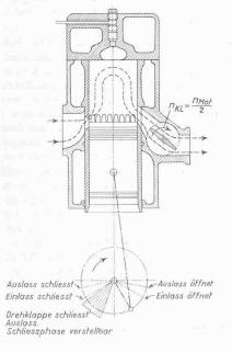
Bild 1 (links). Schematischer Querschnitt durch den Saurer-Zweitakt-Fahrzeug-Dieselmotor mit Quer-Umkehrspülung und Drehklappe im Auslasskanal f. Nachladung
