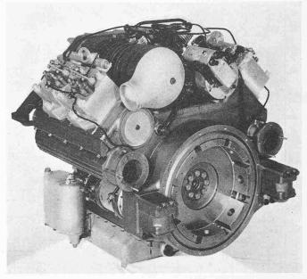
Bild 9. Prototyp des Saurer-Vierzylinder-Zweitakt-Dieselmotors; Bohrung 120 mm, Hub 140 mm, Hubvolumen 6,32 l, Leistung 180 bis 200 PS bei  $n=2000\,\mathrm{U/min}$ . Der Motor bildet die Grundlage für den zwölfzylindrigen Typ, der zum Antrieb von Spezialfahrzeugen vorgesehen ist
