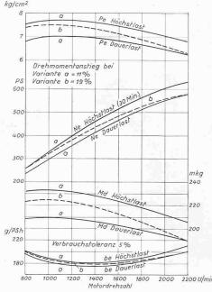
Bild 12. daten des zwölfzylindrigen Motors nach Bild 11
