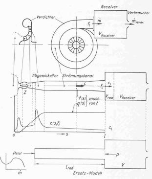
Bild 3. Ableitung eines dynamischen Ersatzmodells für den Verdichter. Das dynamische Verhalten des Verdichers ist gleich dem einer Luftsäule von der Länge  $l_{red}$ . Am linken Ende wirkt der Druck  $p_{stat}$  entsprechend der stationären p,m-Kurve. Rechts wirkt der Druck im Receiver auf die Säule. Der Receiver muss um  $V_{red}$  vergrössert werden, um die Speicherwirkung des Verdichters zu berücksichtigen
