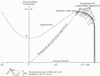
schiebung der Pumpgrenze kann sehr beträchtlich sein. Der Wirkungsgradverlust ist aber für die am Motor vorkommenden Amplituden und Frequenzen sehr gering. (Dies gilt für den untersuchten Verdichter; ohne weitere Messungen mit geänderten Dimensionen ist bei der Verallgemeinerung Vorsicht am Platze).
