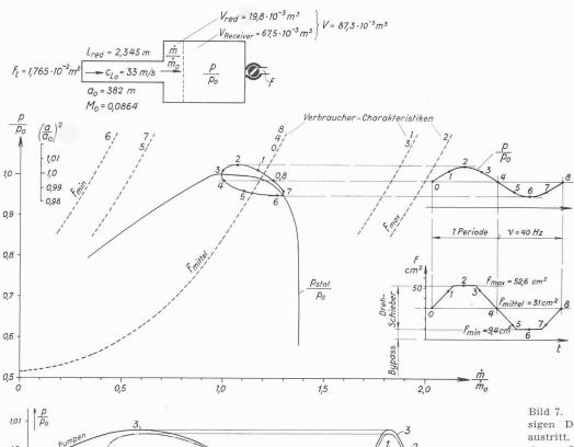
Bild 6. Nachrechnung des Schwingungsvorganges f. die Versuchsanlage nach Bild 2. Der Drehschieber gibt den rechts unten dargestellten Abströmungsquerschnitt frei. Die entsprechenden Abflusscharakteristiken sind im Verdichterkennfeld ein-
