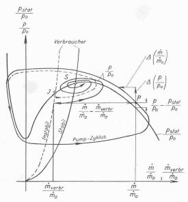
Bild 4. Schrittweise Berechnung des Pumpvorganges nach Bidard. Es wird angenommen, der momentane Zustand am Verdichteraustritt sei durch Punkt P $(p/p_0\ \dot{m}/\dot{m})$ gegeben. Dann bestimmt die in Differenzenform geschriebene Kontinuitätsgleichung, wie sich der Druck im nächsten Zeitintervall  $\Delta\,t$ ändert. Die Bewegungsgleichung gibt die Veränderung des Massenflusses im gleichen Zeitraum. Schrittweise ergibt sich so der ganze Schwingungsvorgang. Es bezeichnen:
