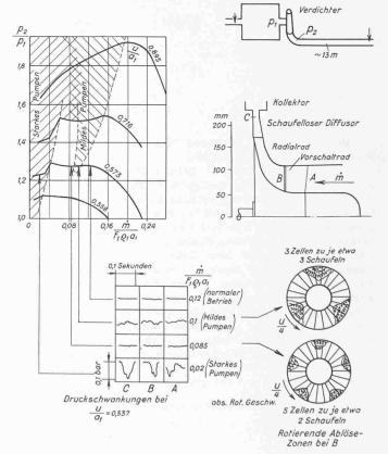
beschränkt, und die möglichen Amplituden nahmen mit steigender Frequenz rasch ab. Daher wurde auch eine Anordnung mit nur ¼ des vorherigen Behältervolumens gemessen. In Bild 9a sind die Pumppunkte aus verschiedenen Messreihen zusammengefasst. Es wurde versucht, durch die nicht allzu zahlreichen Punkte eine Kurvenschar zu legen, die das Ergebnis recht übersichtlich macht. In Bild 9b sind zum Vergleich drei berechnete Kurven aufgetragen.
