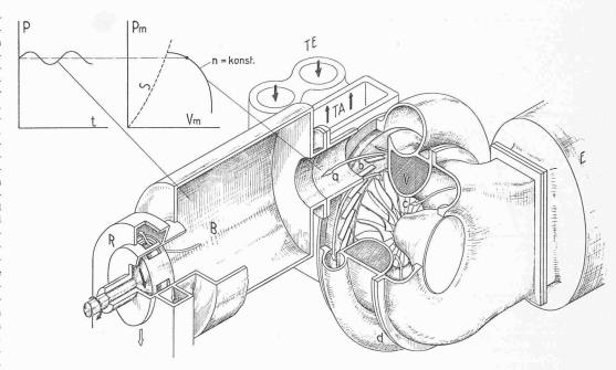
mittels Düse gemessen. Der Antrieb erfolgt durch die mit Druckluft beschickte Axialturbine. TE Drucklufteintritt, TA Luftaustritt
