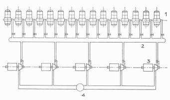
Fig. 2. Disposition schématique du groupe de la fig. 1. 1 générateur, 2 collecteurs de gaz, 3 compresseurs entraînés par les turbines de détente, 4 cheminées
