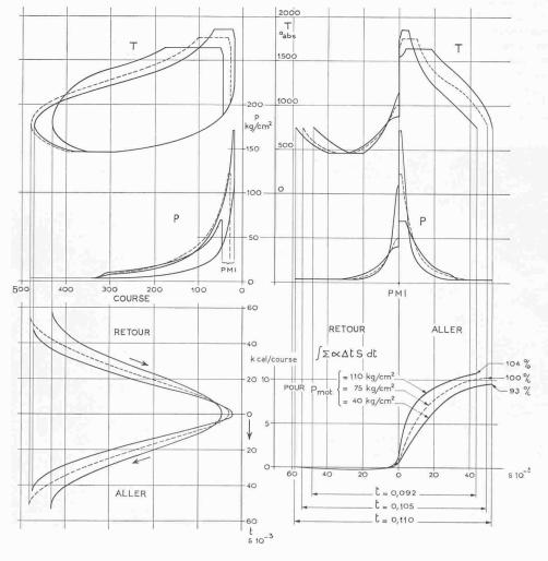
Fig. 4. Comparaison de la transmission de chaleur dans un générateur pour différentes compressions moteur
