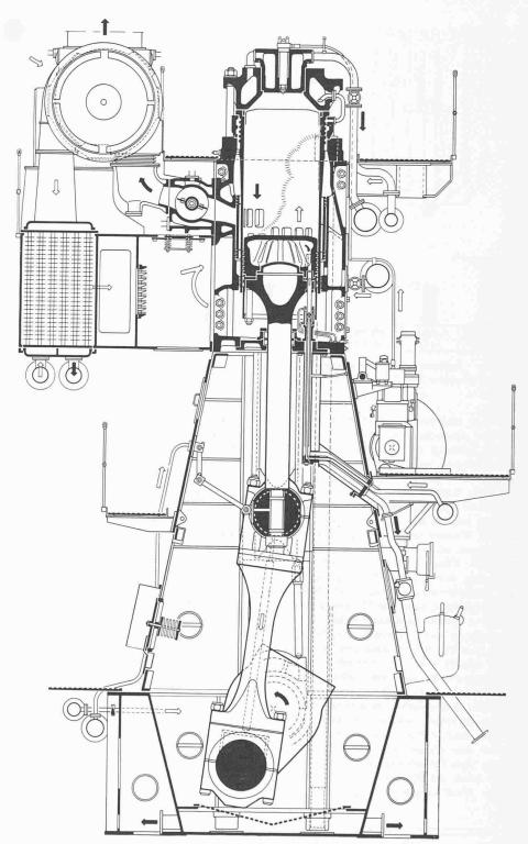
Bild 4. Sulzer-Zweitakt-Schiffsdieselmotor, Baujahr 1960, Bohrung 900 mm, Hub 1550 mm, effektive Zylinderleistung 2300 PS bei 115 U/min (Höchstleistung 3000 PS bei 130 U/min)
