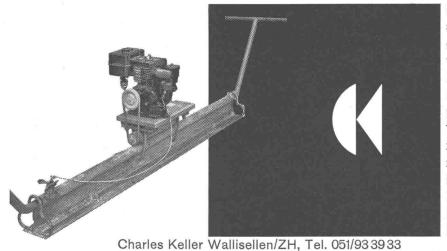
Master Vibrierbalken: ausgerüstet mit aufgebautem Benzinmotor, von einem Ende des Balkens regulierbar. Balken auf Schienenprofil, Auflagefläche 120 mm breit. Horizontal gelegene Spezialvibriernadel, bei Benzinmotorantrieb Fliehkraftkupplung. Modelle von 2-4 m Balkenlänge.
