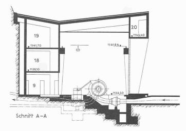
Bild 17. Querschnitt durch die Zentrale Fuhren, 1:300
