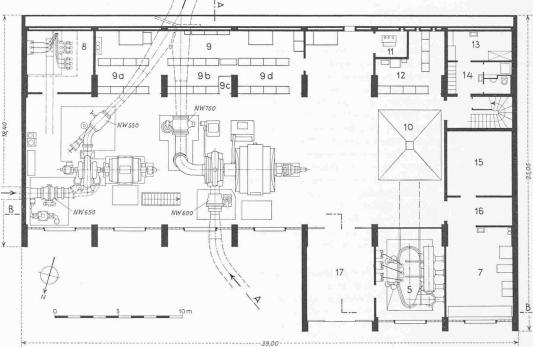
Bild 16. Längsschnitt und Grundriss der Maschinenhalle der Zentrale Fuhren, 1:300
