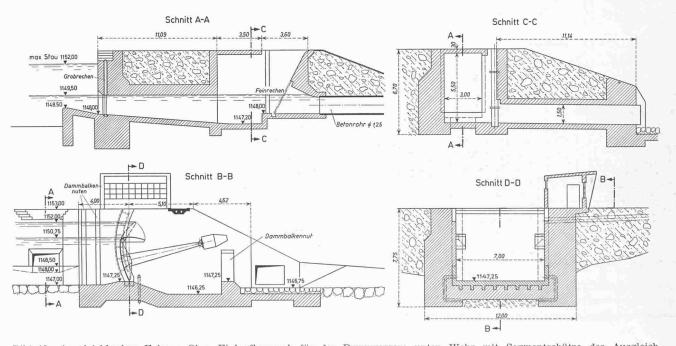
Bild 10. Ausgleichbecken Fuhren. Oben Einlaufbauwerk für das Pumpwasser; unten Wehr mit Segmentschütze des Ausgleichbeckens Fuhren, 1:300
