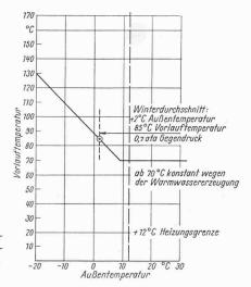
Bild 3. Vorlauftemperatur im Fernleitungsnetz in Abhängigkeit der Aussentemperatur
