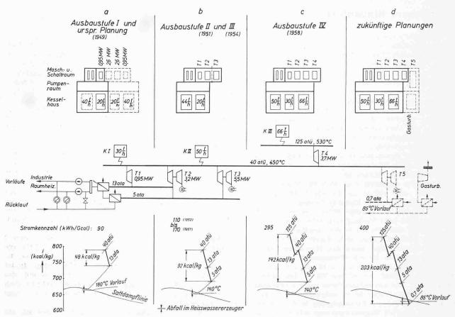
Bild 2. Entwicklungsstufen des Heizkraftwerkes Klagenfurt
