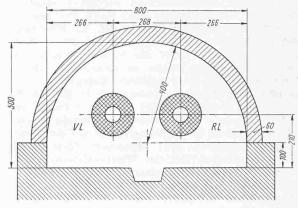
Bild 1. Querschnitt durch einen Heizkanal, VL Vorlauf, RL Rücklauf
