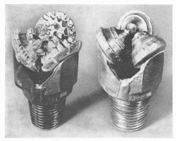
Bild 21. Rollenmeissel, links neu, rechts abgenützt
