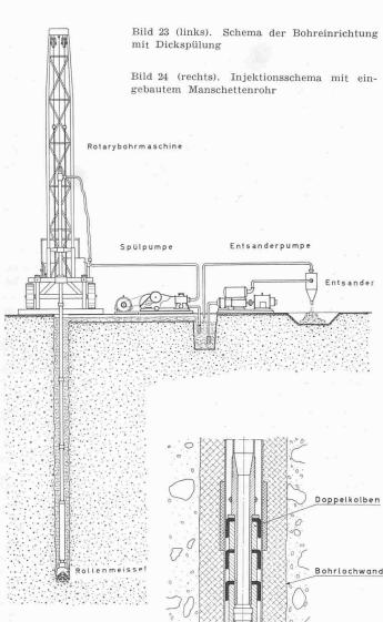
vorbereitete Rinne. Dort ist die Entsanderpumpe eingesetzt, und der ent-Bohrschlamm sandete fliesst dann zurück zur Rotarypumpe, Bild 23.
