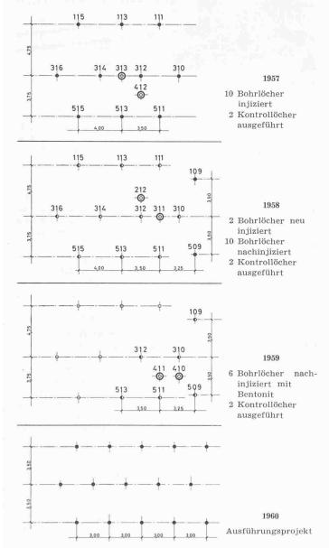
Bild 19. Anordnung der Bohrlöcher für die Injektionsversuche in Mattmark
