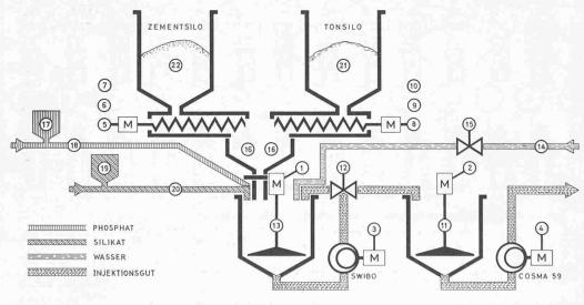
Bild 30. Blindschema. Jedes der sechs Schaltfelder im Kommandoraum weist oben ein solches Schema auf, s. Bild 29
