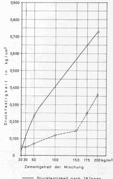
Bild 11 (rechts). Druckversuch mit Tongel, Ton von Holderbank, Raumgewicht der Ton-Wassersuspension  $\gamma=1,18$ . Ausgezogene Kurve: Druckfestigkeit nach 28 Tagen; gestrichelte Linie: Druckfestigkeit nach 7 Tagen
