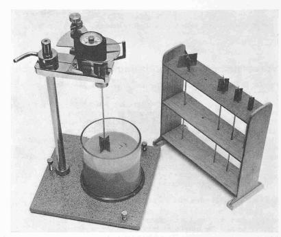
Bild 4. Cohesimeter der Swissboring
