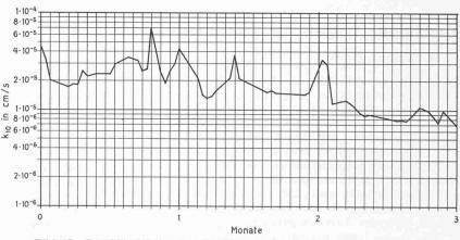
Bild 17. Durchlässigkeit einer Injektionsprobe mit Bentonit bei einem Kiesgerüst 1 bis 2,5 mm; i=10 in Funktion der Zeit. Herkunft des Bentonits: Ponza, Plastizitätszahl 510
