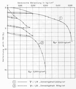
$\operatorname{Bild}$ 9. Spannungs-Zusammendrückungs-Diagramm von Tongel mit Ton von Holderbank, Alter 7 Tage
