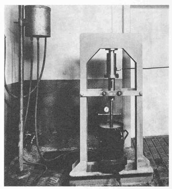
Bild 15. Durchlässigkeitsversuch
