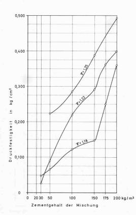
Bild 10 (links). Druckversuch mit Tongel, Ton von Holderbank, Alter 7 Tage
