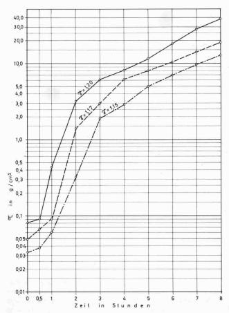
Bild 7. Kohäsion von Tongel, Ton von Holderbank mit einem Zementgehalt von  $80\,{\rm kg/m^3}$  und einem Silikatgehalt von 2~%
