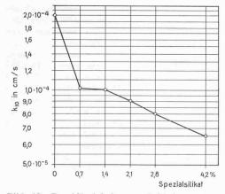
Bild 16. Durchlässigkeit von Injektionsproben mit Tongel bei einem Kiesgerüst von 1 bis 5 mm; i=37.5 in Abhängigkeit des Silikatgehaltes. Ton von Holderbank mit einer Plastizitätszahl 25 bis 28
