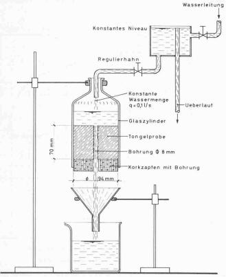
Bild 12. Auswaschversuch mit Tongel, Versuchsanordnung
