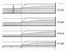
Bild 2. Untersuchte Grundwasserträger - Typen mit den Grundwasserträger-Höhen H'=0.0; 0,4; 0,8; 1,2 H und eingetragener Sickerlinie für  $k/(n_{\rm S}\cdot v)=0.70$  und den Zeitpunkt 32 T.
