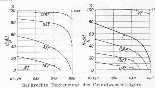
Bild 7. Darstellung der Grundwasserspiegellage (Sickerlinie) für die  $k/(n_s \cdot v)$ -Werte 0,70 und 100,0 in den Messquerschnitten: «Böschung» und 8,7 H (= Modellbegrenzung) für die vier untersuchten
