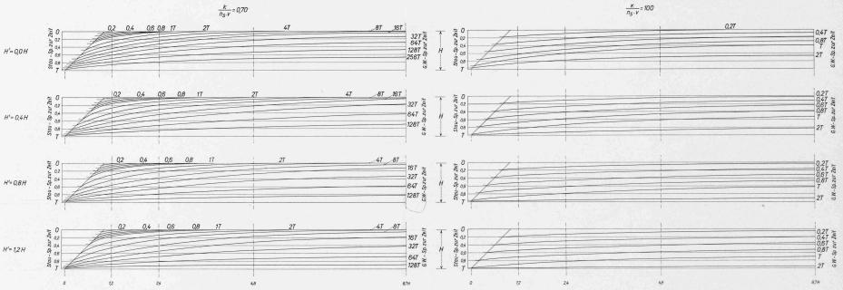
Bild 3. Absenkvorgang: Sickerlinien für verschieden tiefe Grundwasserträger  $(H'=0.0\,H;~0.4\,H;~0.8\,H;~1.2\,H)$  mit der Zeit T als Parameter. Linke Reihe: schnelles Absenken,  $k/(n_s \cdot v) = 0.70$ . Rechte Reihe: langsames Absenken,  $k/(n_s \cdot v) = 100.0$ . Der Berührungspunkt der Sickerlinie mit der Böschung ist mit einem kurzen horizontalen Strich markiert  $(L'=5.0\,H;~L=8.7\,H,~B\"{o}schungsneigung~1:1)$ .
