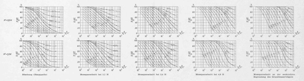
Bild 4. Absenkvorgang: Darstellung der Grundwasserspiegellage (Sickerlinie) für beliebige  $k/(n_s \cdot v)$ -Werte in den Messquerschnitten (siehe senkrechte Reihen): «Böschung»; 1,2 H; 2,4 H; 4,8 H und 8,7 H (= Modellbegrenzung). Die berücksichtigten Grundwasserträgertiefen sind H' = 0.0 H und 1,2 H. Die Kurven 0,2 bis 1,0 T nähern sich für Werte  $k/(n_s \cdot v) > 10^3$  asymptotisch den entsprechenden Vorfluterwasserspiegeln.
