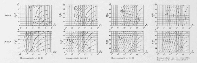
Bild 6. Füllvorgang: Darstellung der Grundwasserspiegellage (Sickerlinie) für beliebige  $k/(n_s \cdot v)$ -Werte in den Messquerschnitten (siehe senkrechte Reihen): 1,2 H; 4,8 H und 8,7 H (= Modellbegrenzung). Die berücksichtigten Grundwasserträgertiefen sind H' = 0,0 H und H' = 1,2 H.
