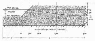
Bild 1. Schematische Darstellung des Grundwasserträgers: links Vorfluter mit variablem Wasserspiegel, unten «undurchlässige Schicht», rechts senkrechte undurchlässige Modellbegrenzung. Eingetragen sind die Schnitte  $1,2\,H$ ;  $2,4\,H$ ;  $4,8\,H$  und  $8,7\,H$ , in denen der Grundwasserspiegel speziell untersucht wurde. Dargestellt ist ein Füllvorgang.  $L=8,7\,H$ ;  $L'=5,0\,H$ .
