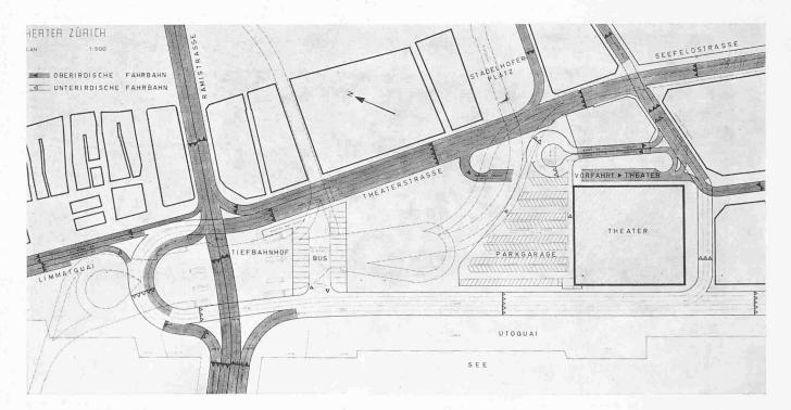
Entwurf Nr. 75 (4. Rundgang). Die Lösung ist sauber konstruiert und gut in bezug auf Orientierung. Die Hauptrichtungen sind kreuzungsfrei und direkt geführt, wenn auch teilweise zu wenig gestreckt. Diese Vereinfachungen konnten aber nur damit erkauft werden, dass die Seefeld-
