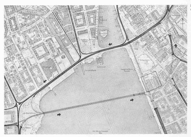
Entwurf Nr.62 (4. Rundgang). Der Verfasser schlägt einen zweiten Seeübergang als Gegenrichtung zur Seebrücke vor (Einbahnstrassenpaar). Die möglichen Vereinfachungen insbesondere bei kreuzungsfreier Führung sind offensichtlich. Unzumutbar sind aber sicher die grossen Umwege,
