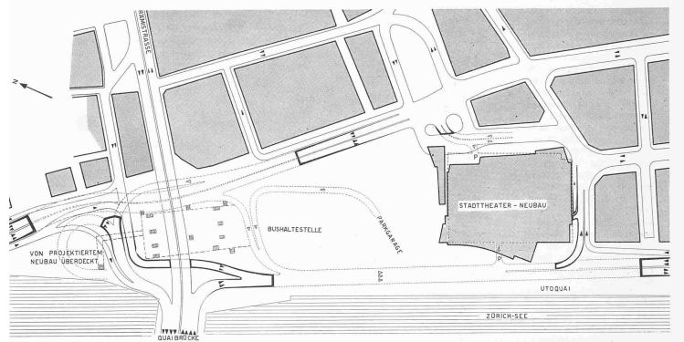
Entwurf Nr. 61 (4. Rundgang) zeigt eine sehr sorgfältig durchkonstruierte, in den Hauptrichtungen vollkommen kreuzungsfreie Lösung ohne grössere Umwege. Die Nebenstrassen werden an einen sehr grossen Kreisel angeschlossen. Die Radien der Verbindung Utoquai—Seebrücke sind etwas zu knapp geraten, und ihre Linienführung scheint erzwungen. Gut gelöst sind auch die Busverbindungen nach
