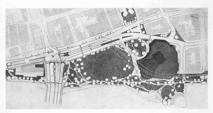
Entwurf Nr. 50 (4. Rundgang). Der grösste Verkehrsstrom vom Utoquai wird mit jenen aus Richtung Seefeldstrasse und Kreuzbühlstrasse zusammengefasst und unterirdisch und kreuzungsfrei auf die Seebrücke geführt. Daneben entsteht oberirdisch eine rechtwinklige Niveaukreuzung zwischen dem Hauptverkehrsstrom Rämistrasse—Seebrücke und dem noch verbleibenden unbedeutenden Verteil-
