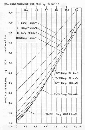
Bild 3. Beschluss der Expertenkommission: Zuschlagsfaktor  $f_1$  für Zunahme der CO-Produktion von Last- und Gesellschaftswagen bei freier, gehemmter und stockender Fahrt auf horizontalen Strecken und Steigungen
