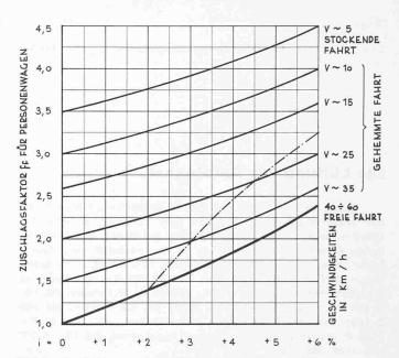
Bild 2. Beschluss der Expertenkommission: Zuschlagsfaktor  $f_f$  für Zunahme der CO-Produktion von Personenwagen bei freier, gehemmter und stockender Fahrt auf horizontalen Strecken und Steigungen. Strichpunktiert ist die Grenzlinie der Dauergeschwindigkeit von Lastwagen auf Steigungen (vgl. den bezüglichen Bericht des Institutes für Strassenbau an der ETH von 1957)
