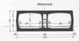
Bild 3. Querschnitte 1:400 durch Tunnel mit Rampen
