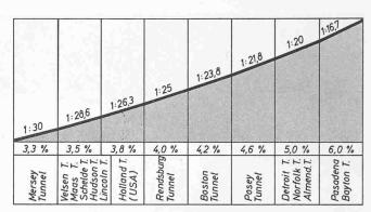
Bild 1. Zusammenstellung der Rampenneigungen von ausgeführten Unterwassertunneln
