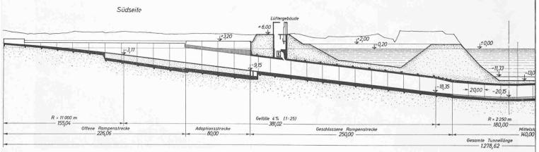
Bild 2a. Strassentunnel unter dem Nord-Ostsee-Kanal, Längsschnitt, Längen 1:3300, Höhen 1:1100
