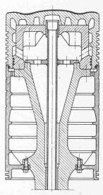
Bild 10. Arbeitskolben für Grossmotoren mit Oelkühlung, links: bisherige Bauart, rechts: neue Bauart
