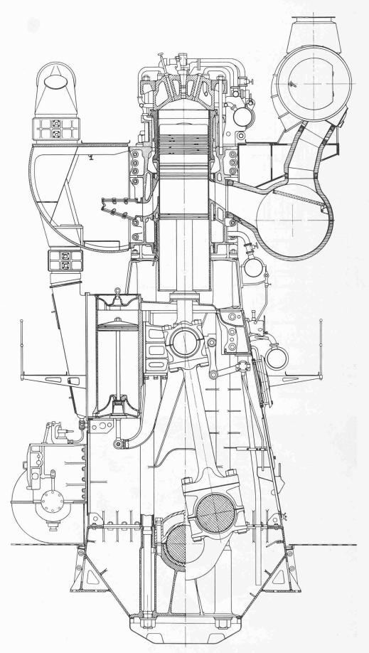
Bild 2. Querschnitt durch einen Zylinder des Motors 909 S, 1:50
