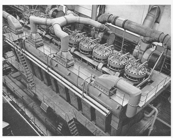
Bild 9. Ansicht des Motoroberteils mit Abgas-Turbogebläsen, Zylinderdeckeln, Spülluftleitungen und Luftkühlern, 1. Stufe
