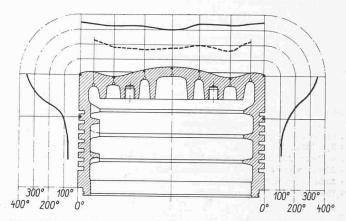
Bild 11. Verlauf der Wandtemperaturen am dünnwandigen Kolbenoberteil des Motors 900 S bei  $p_{me}=7.7~{\rm kg/cm^2}$ , ausgezogene Linien: Aussenseite, gestrichelte Linie: Innenseite
