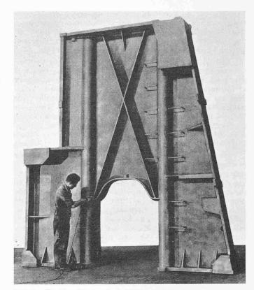
Bild 4. Einzelne Ständerwand in geschweisster Ausführung
