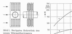
Bild 2. Wärmeübergangszahl auf der Luftseite in Abhängigkeit der grössten Luftgeschwindigkeit; a bei durchbrochenen Rippen, b bei glatten Rippen
