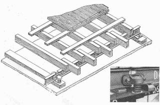
Bild 17. Schwingboden System «Valtor» und Bild 18 (rechts: blockierbare Spiralfeder
