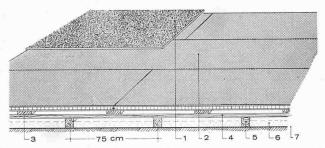
Bild 8. Schwingboden System Andres. 1 Plastikbelag, 2 Grisopanplatte 22 mm, allseitig mit Nut, Feder in Anticorodal, oberes Lager  $24 \times 120$  mm, 4 unteres Lager  $24 \times 120$  mm, 5 Bodenlager  $60 \times 70$  mm, direkt auf heissen Asphaltin-Ueberzug verlegt, 6 imprägnierte Reisspreuer, 7 Asphaltinbelag
