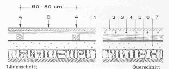
Bild 6. «Halber» Schwingboden mit elastischem Oberbelag. 1 Bodenhohlraum (die Holzunterkonstruktion soll dauernd von Luft umspült sein), 2 Kunststoffbelag 2,5 bis 3,5 mm, 3 harte oder halbharte Holzfaserplatte (Pavatex/Grisotex), 4 Reformboden oder Bretterboden 24 mm, 5 Bodenlager 6×6 cm, 6 Sperrschicht bei nicht unterkellerten Räumen (z. B. Dachpappe, überlappt und verklebt), 7 Beton P 200
