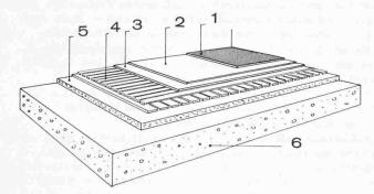
Bild 13. Holländischer Sporthallenboden mit Exponential-Federkraft. 1 Korklinoleum 4 mm, 2 harte Holzfaserplatte 4 mm, 3 Filz 10 mm, 4 Bretterlager  $10\times100$  mm, Zwischenräume 1 cm, 5 amerikanisches Fiberglas 25 mm, 6 Betonboden
