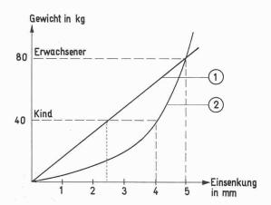
Bild 1. Kraft-Einsenkungs-Diagramm für Böden.
