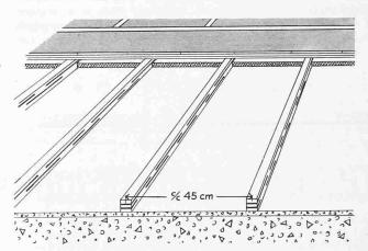
Bild 10. Holmsund Gymnastikgulv. Belag Korklinoleum, Unterlage Hartfaserplatte, verleimte Lamellenriemen, Schwingbodenlager 80 mm (Distanzen 45 cm, mit Isolierfüllung)
