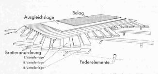
Bild 9. Kontinuum-Federboden. Belag Korklinoleum 6,5 mm, Ausgleichslage harte Holzfaserplatte
