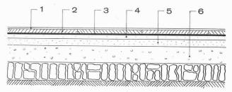
Bild 5. Plastisch-elastische Bodenkonstruktion. 1 Krommenie Cork, 6,5 mm (für Turnhallen nach dem plastisch-elastischen Prinzip besser geeignet als Giubiasco-Korklinoleum), 2 Celotex, 9 mm (evtl. 18 mm), 3 Asphalt-Sperrschicht, 4 Zement-Glattstrich 2 cm, 5 Zement-Kieselgemisch, 3 bis 5 cm stark, 6 Betonboden, 15 bis 20 cm
