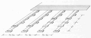
Bild 7. Elasto-Spezial-Langriemenboden in Nut und Kamm 24 mm. Bretter für das obere Lager 120  $\times$  40 mm, für das untere Lager 120  $\times$  33 mm
