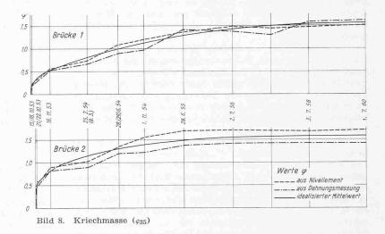
Die Versuche sollen in Abständen von 1 bis 2 Jahren in gleicher Weise weitergeführt und erst abgeschlossen werden, wenn das Verhalten der Brücke mit Sicherheit stationär geworden ist.
