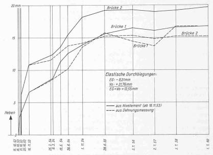
Bild 7. Durchbiegungen infolge Kriechen des Betons
