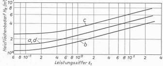
Bild 1. Heizflächenbedarf für Austauscher mit fluchtender Rohranordnung, abhängig von der Leistungsziffer für 1000 kcal/h und  $\Delta t_m = 1^{\circ}$  C.
