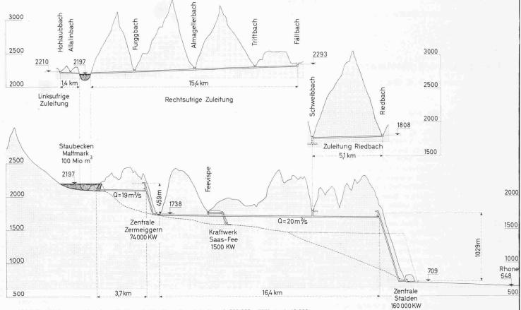
Bild 2. Längenprofile der Mattmark-Kraftwerke. Längen 1:200 000, Höhen 1:40 000
