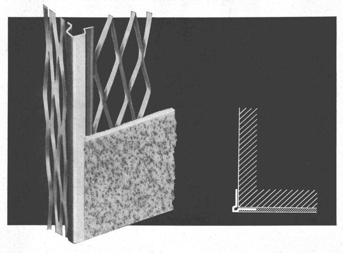
Mauerkanten werden oft leicht beschädigt, HESCO-Eckschutzleisten schützen Mauerkanten vor jeder Verletzung. Das feingliedrige, maschenartige Streckmaterial zu beiden Seiten der Schutzkante verbindet sich vollkommen mit dem Mörtel. Die Eckschutzleiste ist promatverzinkt, rostet also nicht. Lager-Längen 150, 180 und 200 cm in Bünden à 10 Stück.
