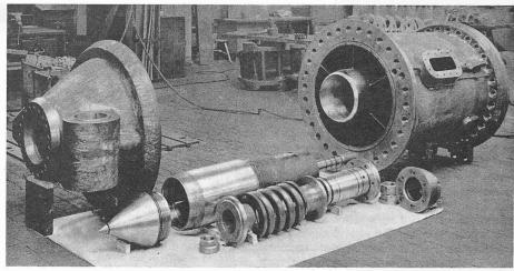
Bild 5. Düse mit Düsennadel und Innenteilen
