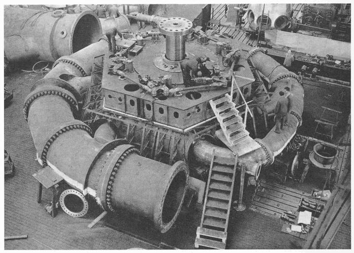
Bild 4. Zusammengebaute Turbine im Herstellerwerk
