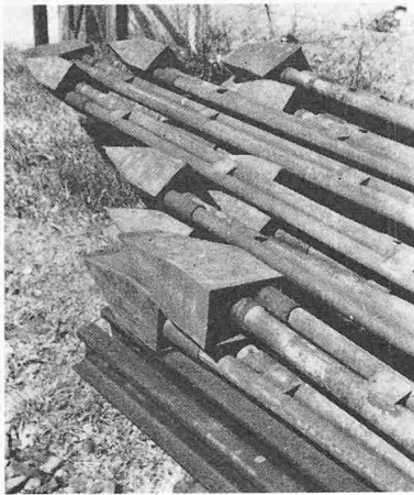
Bild 3. MV-Zuganker mit gesondert geführter Verpressleitung
