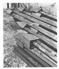
Bild 3. MV-Zuganker mit gesondert geführter Verpressleitung
